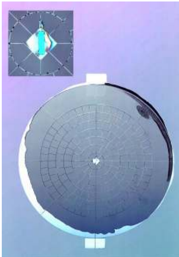
Figure 17 : Vue du 'Spider Web Bolometer'
